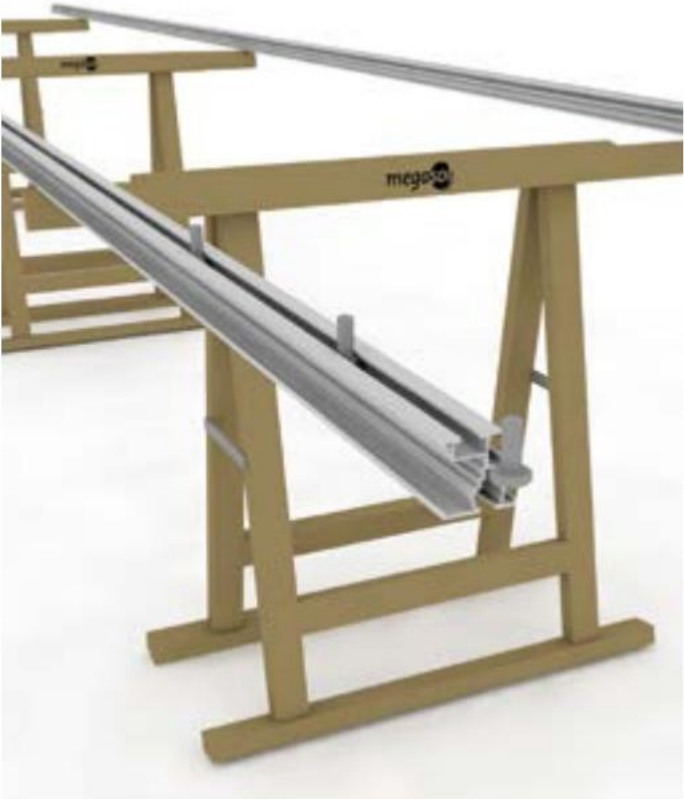
1 Placer LOCKUP skinnen på Megasol bukke og indsæt M10x25 sekskant skruer i skinnen.
