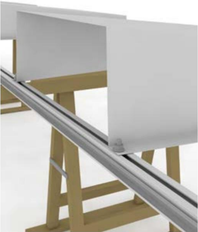
2 Placer Flatport-bakkerne på hovedet på skinnerne, og spænd dem med M10-flangemøtrikker.
