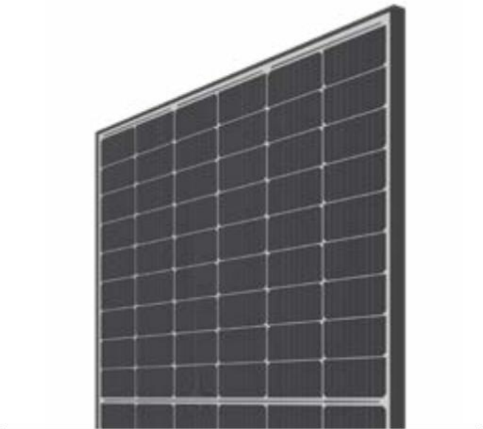
Mono HiR Bifacial M10 HC108 | Hvid Celletype: n-type HiR M10 (182 mm) Matrix: 108 halvskårne celler Stel: U30 sort Celleafstandsfarve: hvid (delvis udskrivning)
