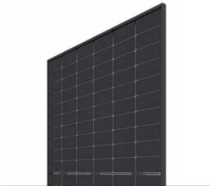
Mono HiR Bifacial M6 HC120 | Fuld sort optik Celletype: n-type HiR M6 (166 mm) Matrix: 120 halvskårne celler Stel: U30 sort Celleafstandsfarve: gennemskinnelig
